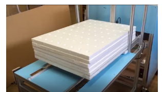
↓ 下のパネルから順に パネル洗浄機「ぴか介」に自動挿入
